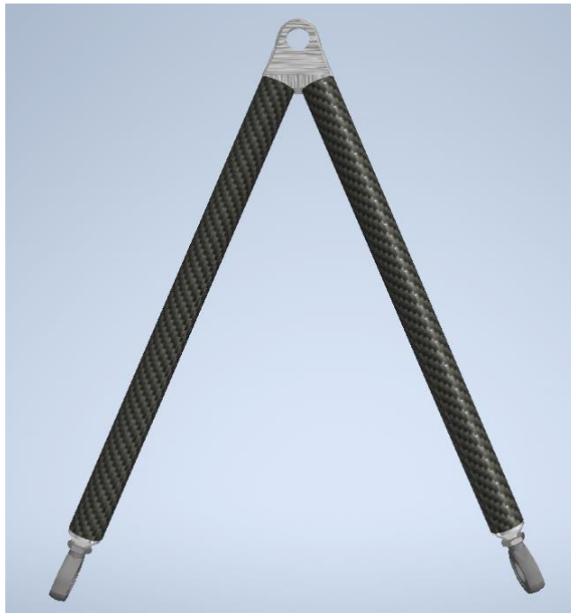
Figur 3.10.1: Triangelarm design benyttet på dagens biler hos ION Racing. Triangelarmen består av et Y-stykke, to karbonfiber rør, to aluminium braketter og to stav-ende lager (Rod end bearing). Y-stykket brukes for å feste karbonfiberrørene sammen. Aluminiumbrakettene limes inn i karbonfiberrørene for å lage gjenger til stav-ende lagerene.
