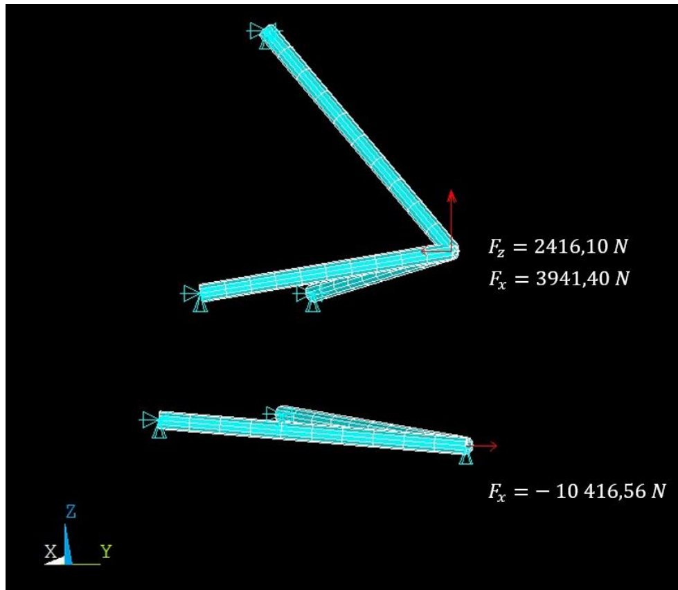
Figur 6.7.5: Last situasjon på hjuloppheget under maksimal sving, ført inn i ANSYS Mechanical APDL.
