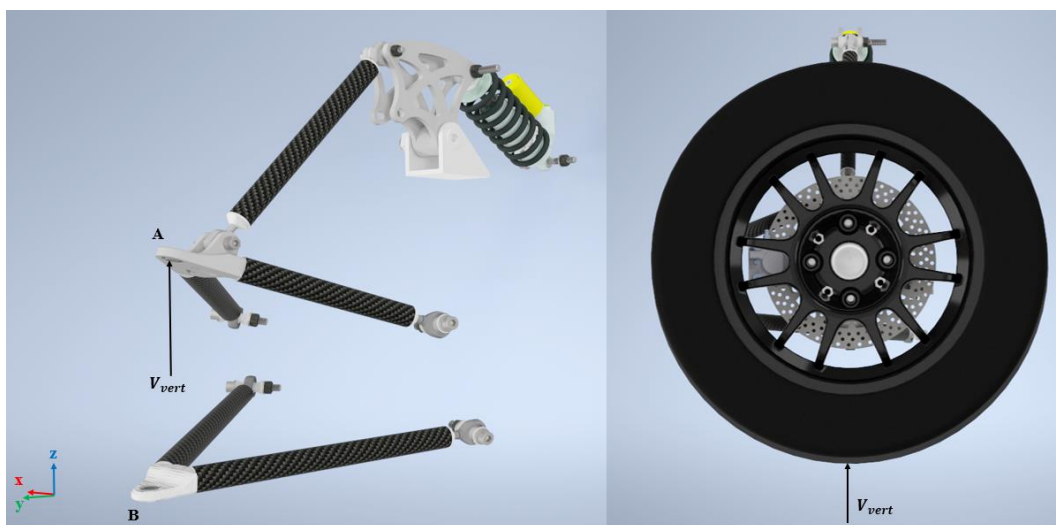
Figur 3.4.1: Fordeling av krefter under maksimal statisk bevegelse til venstre. Her vil kun vertikal last virke, og krefter vil derfor kun gå gjennom triangelarmen festet til demperen. Krefter som vil virke på dekket fra bakken vises til høyre.
