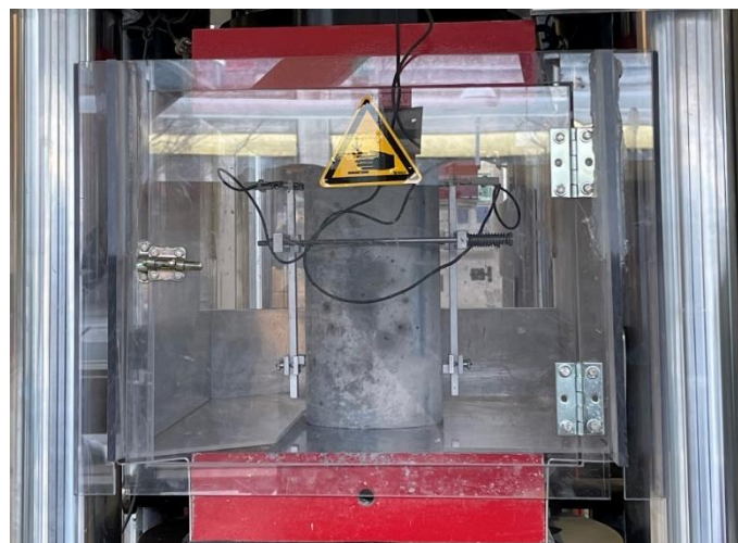
Figur 3 Sylinder – prøvestykket gjennomgår test av E-modul
