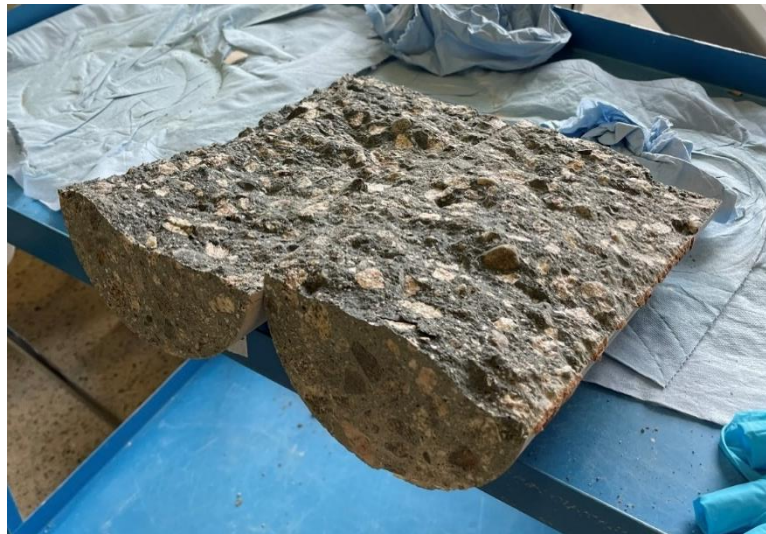
Figur 4 Resultat som viser innside av prøvestykket etter spaltestrekkfasthet-test
