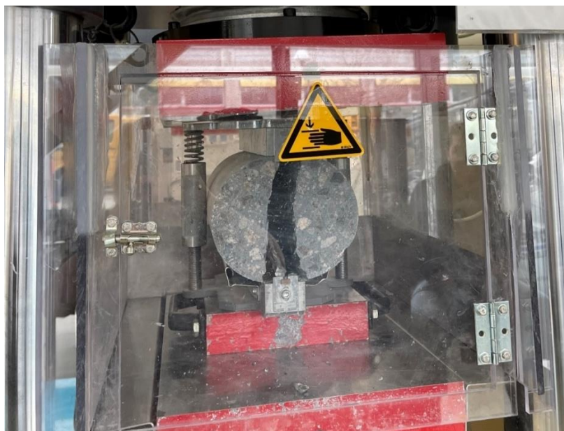
Figur 5 Resultat etter spaltestrekkfasthet-test i maskin
