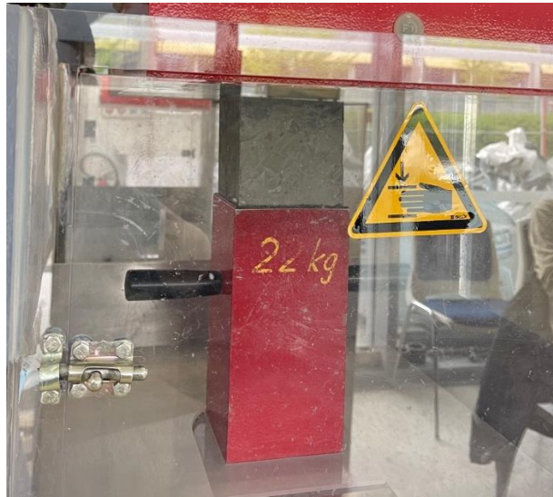
Figur 2 Terning - prøvestykket gjennomgår kompresjonstest
